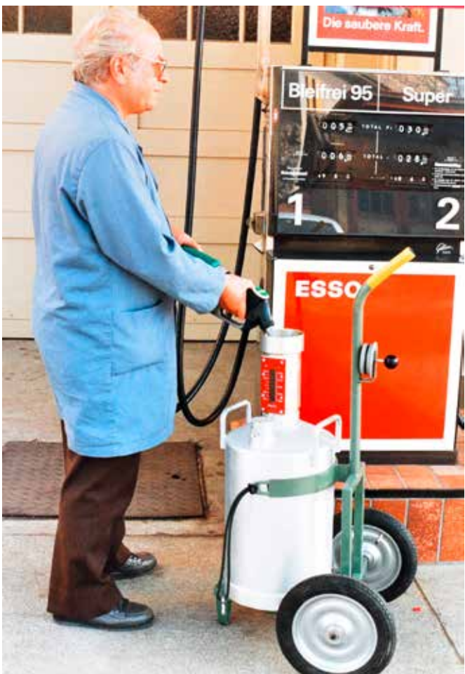
Eichmeister Reinhold Dinkel beim Überprüfen einer Waage und einer Tanksäule. (Bilder: zVg Peter Dinkel)
